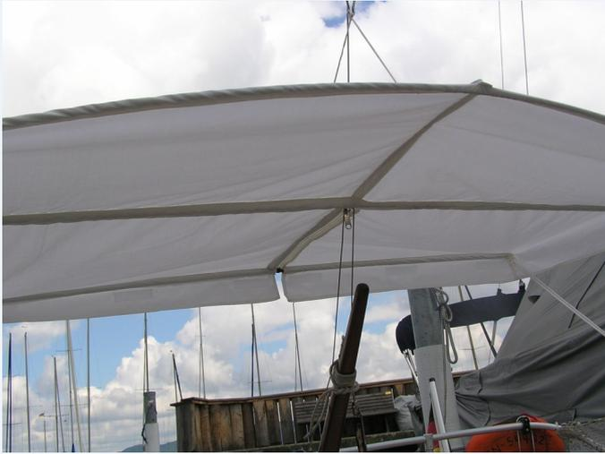
Dieses ausgeklügelte System hat jedoch einen kleinen Nachteil: Durch sein stabiles Gestänge und die geringen Durchmesser der Achterstage ist der große Sunsave auf kleineren Booten unter 7m nicht einsetzbar.
