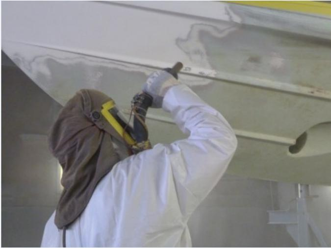
Zunächst wird das Gelcoat und geschädigte Laminat im Shotblast-Strahlverfahren vollständig entfernt .
