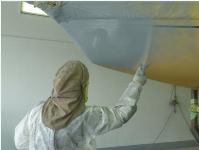
Nach Austrocknen des Rumpfes bei ca. 40°Celsius wird ein spezielles Vinylester Klebeharz in den durch das Strahlen aufgerauten Untergrund eingearbeitet, dies dient der Sicherstellung einer 100%igen Haftung auf dem vorhandenen Laminat.
